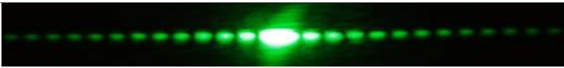
Рис.18. Центральный штрих длиной 5,5мм при расстоянии до экрана D=2,1 м.
