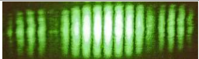
Рис. 28. Развѐртка щелью 2 под малым углом к горизонтали центрального штриха развѐртки луча щелью 1.
