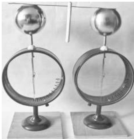
Рис. 3. Контактное соединение электрометров.
