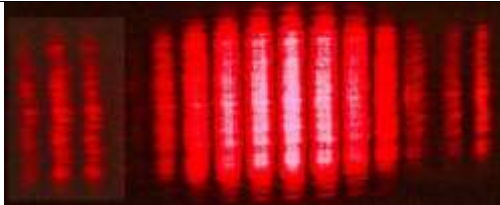
Рис. 28. Развѐртка щелью 2 под малым углом к горизонтали центрального штриха развѐртки луча щелью 1.
