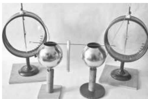
Рис. 4. Схема с разделением заряжаемых тел и измерительных приборов
