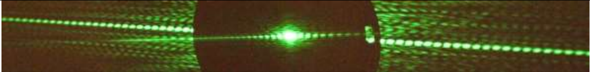
Рис. 28. Развѐртка щелью 2 под малым углом к горизонтали центрального штриха развѐртки луча щелью 1.
