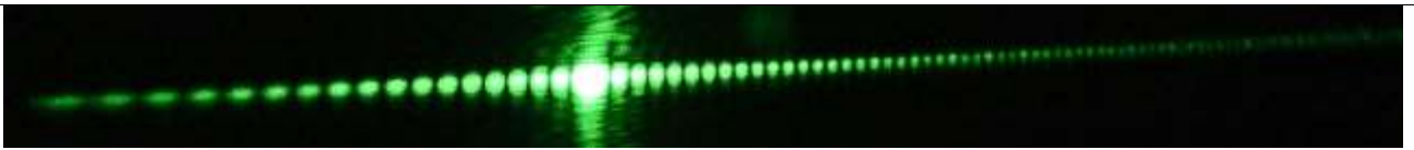
Рис. 26. Отраженный от поверхности бруска луч. До экрана 5,25 м (увеличено).
