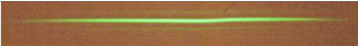
Рис. 17. Центральный штрих длиной 216 мм при расстоянии до экрана D=5,2 м.
